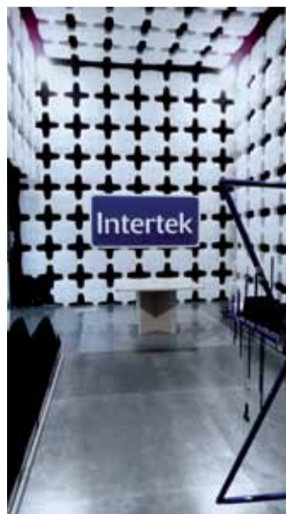
La camera semi anecoica per prove di compatibilità elettromagnetica. A destra, il sistema di miscelazione gas per prove antideflagranti - Laboratorio ATEX/IECEx/HazLoc.
