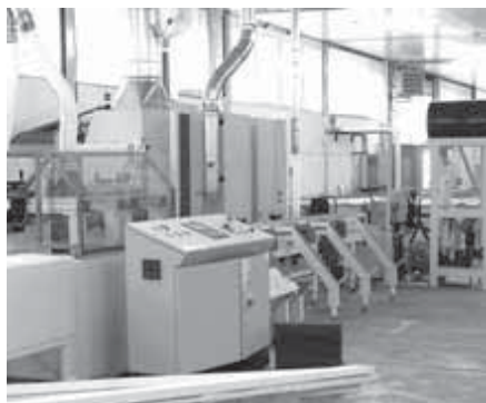
Impianto automatico per la produzione di travi lamellari e pareti in legno strutturali. A destra una linea di levigatura su quattro lati.
